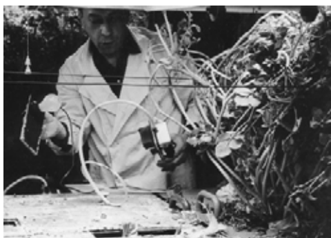
Установка для бессубстратного выращивания картофеля (Симонов В.М.)
